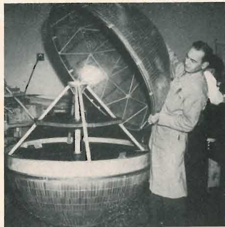
Dettaglio di costruzione del satellite Courier rilasciato dal dipartimento della difesa degli Stati Uniti. Le strutture in fibra di vetro, vengono montate su un modello al naturale per collaudare l'idoneità di ogni parte.
