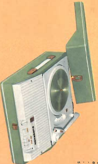
Transistor SB 60 (tipo esportazione) - 7 Transistori + 2 Diodi - circuiti stampati - Gamme OM e OC oppure OM e OL - Altoparlante mm. 100 - pot. d'usc. 350 mW. - Batterie n. 2 da 4,5 Volts. - Autonomia 500 h. - Mobile in plastica con custodia - Dimensioni: 22 x 6,5 x 15 - Peso: Kg. 1,250.
